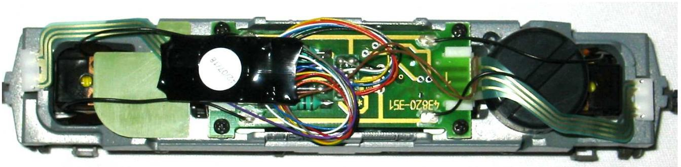
Der Lautsprecher wird einfach unter das Flex-Kabel geschoben, dabei das Flex-Kabel direkt an der Hauptplatine nach oben knicken. Eine Verklebung ist nicht nötig!
