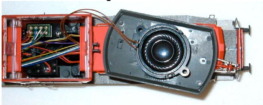
**Und zum Abschluss: Wenn sie die Schlitze in der Schallkapsel vor dem Einbau mit Epoxy oder UHU-Plus verschließen, klingt's nachher noch besser.**
