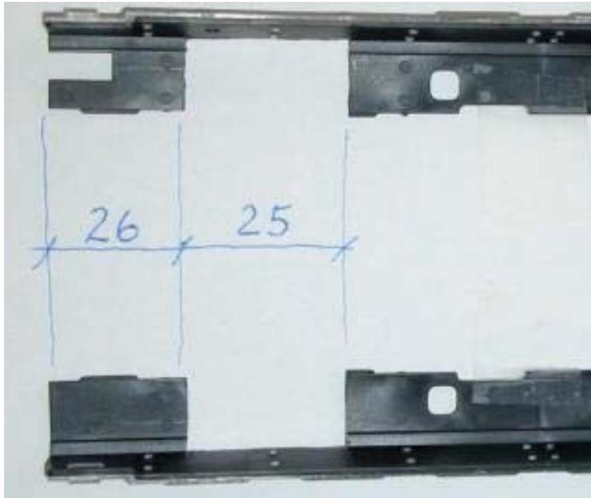
Montieren Sie den Lautsprecher auf kleinen Leisten (z.B. 3x2 Kieferleiste, Zündhölzer?) am Guß-Chassis genau unter dem Ausschnitt der Fensterbänder (im Kardanbereich).
