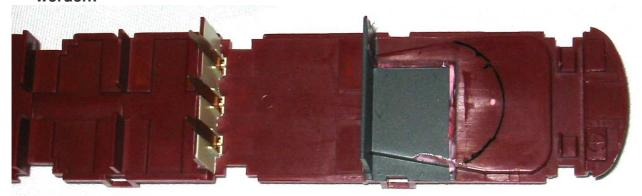
Die Kontur der Schallkapsel wie oben dargestellt anzeichnen und die Fläche zwischen der Kontur und der verbliebenen Trennwand ausschneiden. Nur den erhöhten Bereich (Stufe) ausschneiden, der Ausschnitt wird also nicht kreisrund.
