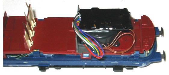
Der Decoder wird mit doppelseitigem Klebeband genau in der oben dargestellten Lage auf der Schallkapsel befestigt.
