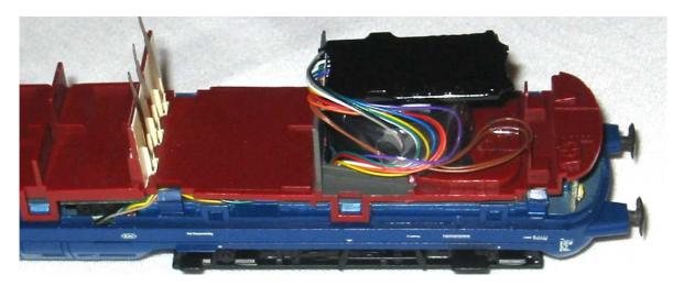
Vergessen Sie nicht, den DIP3 Schalter an der Unterseite des Fahrzeuges auszuschalten, sonst brennt die Innenbeleuchtung ständig.
