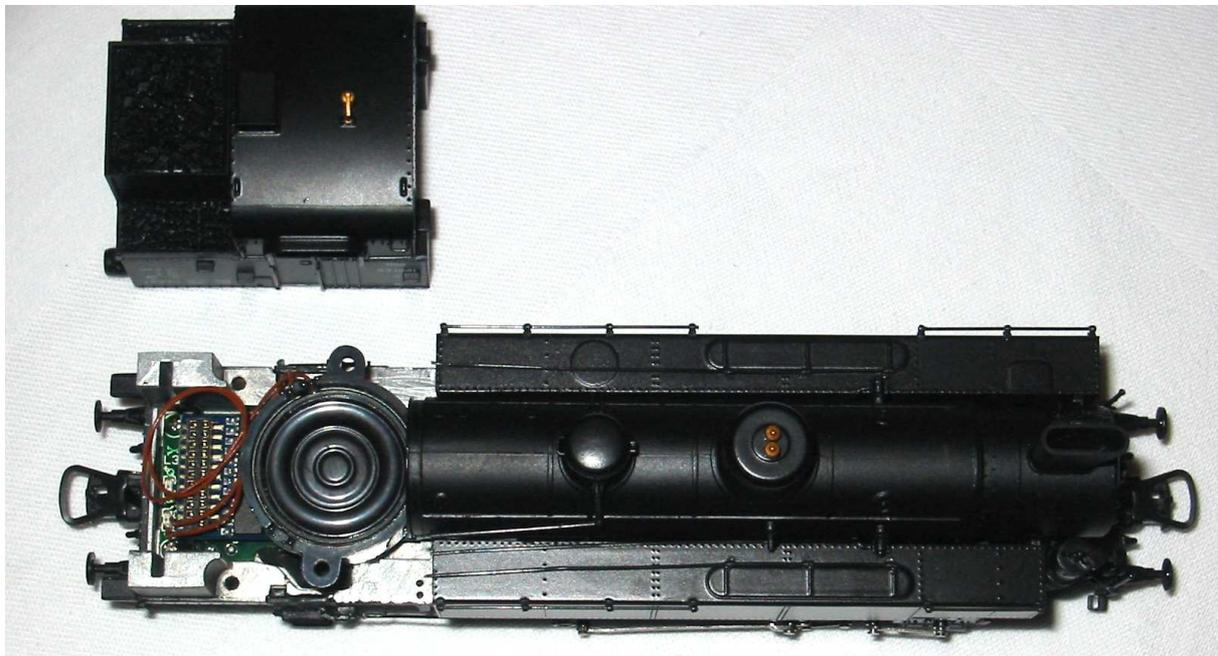
**Das Foto zeigt die Verwendung eines Lautsprechers mit 20mm Durchmesser ( ESU-Artikel 50441 bei uns erhältlich).**
